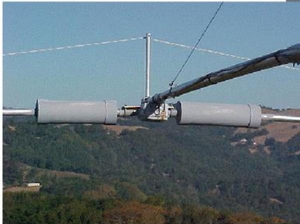
180S element on Sigma 280S Yagi.
